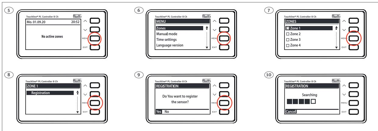
**(DK)** Tilmeld en rumtermostat til en kanal på kontrolenheden. Alle el-forbindelser til pumpe, termomotorer og evt. relæ skal udføres inden der sættes 230V til kontrolenheden, se monteringsvejledningen for dette.
