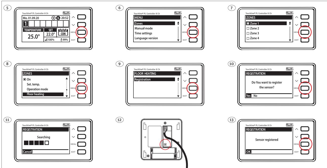
**(DK)** Gulvføleren kan kun anvendes i kombination med en rumtermostat. Så tilmeld først rumtermostaten til kanalen og derefter gulvføleren til samme kanal. Alle forbindelser til pumpe, termomotorer og evt. relæ skal gøres inden der sættes 230 V til kontrolenheden. Tryk på den lille knap kortvarigt (se tegning 12) når der i displayet står "Searching".
