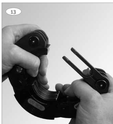
13: Vid pressning av 40, 50 och 63 mm används Roths ringbackar.
